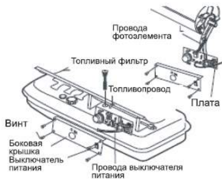
Рис. 21 Установка топливного фильтра
