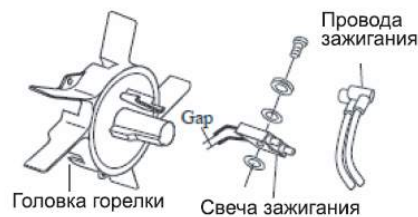
Рис. 18 Установка свечи зажигания
