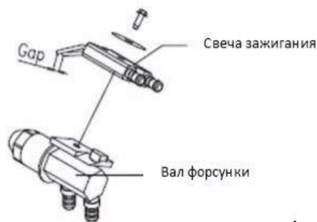
Рис. 18 Установка свечи зажигания
