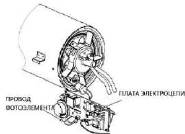
Рис 9 Положение фотоэлемента
