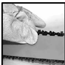
Натяжение цепи установлено правильно, если потянув вверх, ее можно приподнять на 5 мм под действием силы 10Н, и при этом цепь можно протянуть вдоль шины вручную. Проверьте правильность установки цепи на ведущую и ведомую звездочки, потянув цепь вперед по пильному полотну. Цепь должна скользить без заеданий.
