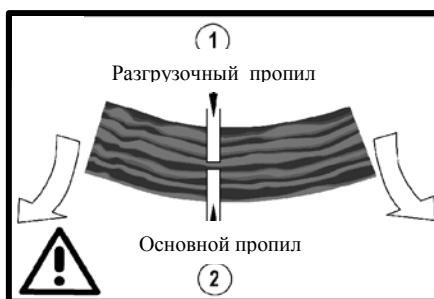
Нижняя часть дерева под напряжением. Опасность: дерево сдвинется вниз.
