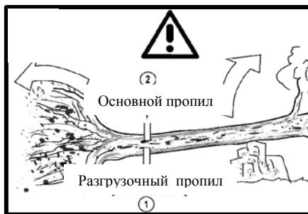
Толстый ствол с комлевой частью под напряжением. Опасность: дерево может сдвинуться в любую сторону. Сначала всегда отпиливается комлевая часть.
