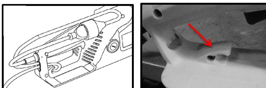
Запустите пилу. Плотно установите зубчатый упор на дереве. Поднимите пилу за заднюю рукоятку(1) и слегка нажимая на переднюю (2), производите распил дерева. Отодвиньте пилу немного назад, переместите зубчатый упор вниз и произведите допил дерева.
