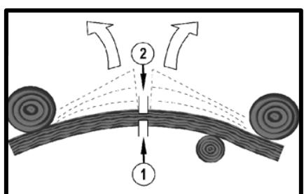
Оба конца дерева зажаты и находятся под напряжением. Опасность: дерево сдвинется вверх и в сторону.
