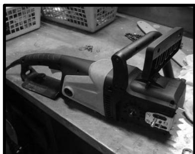
После работы очищайте все части электропилы. Не используйте бензин или прочие горючие жидкости для очистки корпуса, пильного полотна и других рабочих частей пилы.
