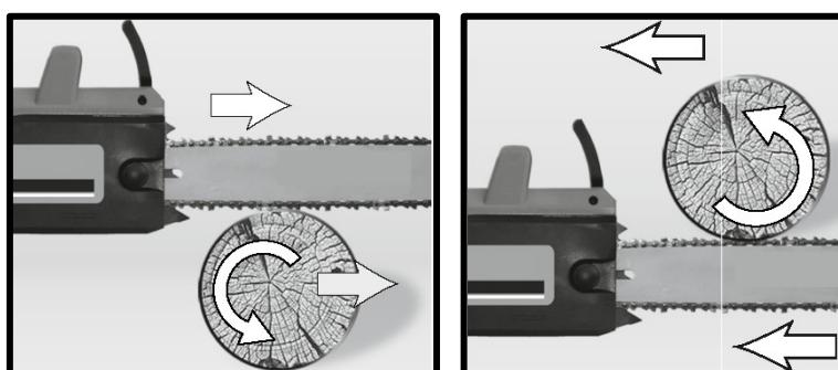
При неправильной распиловке древесины цепь может быть зажата бревном. Чтобы этого не произошло, определитесь, каким образом вы будете проводить распиловку древесины.
