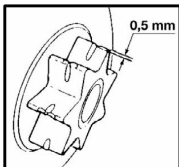
Проверить на предмет наличия трещин и изношенности, мешающих работе привода цепи. При чрезмерном изнашивании, необходимо заменить звездочку на новую. Никогда не надевайте новую цепь на изношенную звездочку или изношенную цепь на новую звездочку.
