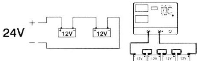
При последовательном подключении, наоборот, суммируется напряжение аккумуляторов, а ток зарядки остается одинаковый, в соответствии с установленным значением.
